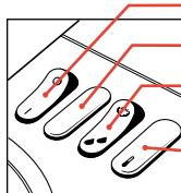
Comutador “Ligado/Desligado” I = Ligado / O = Desligado
