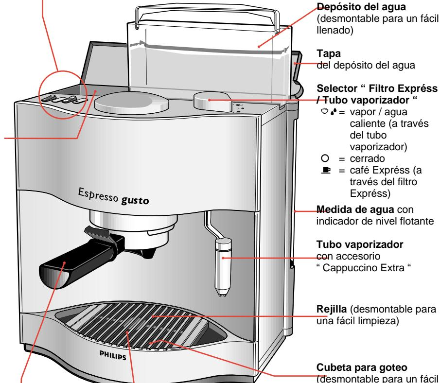
Depósito del agua (desmontable para un fácil llenado)
